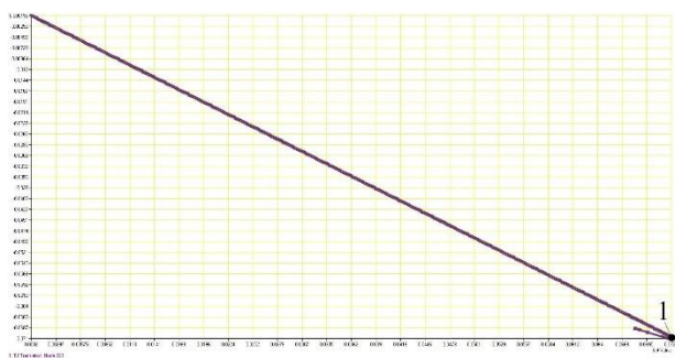
Рисунок 10. Кривая равновесных состояний для средней точки нижнего пояса фермы с жесткими узлами (материал – упругопластический с реальной диаграммой).
