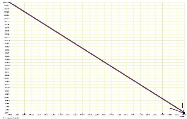
Рисунок 8. Кривая равновесных состояний «прогиб – нагрузка» для средней точки нижнего пояса фермы с жесткими узлами (материал – упругопластический с билинейной диаграммой).
