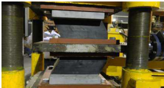
Рис. 4. Испытание эластомерной опоры на сдвиг.
