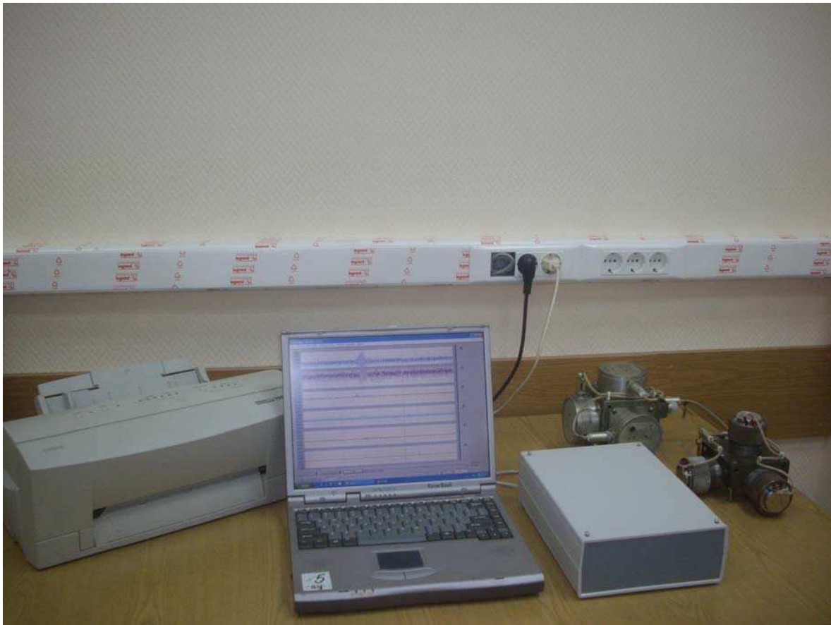
Рисунок 2. Общий вид станции СВД-60МВ.
