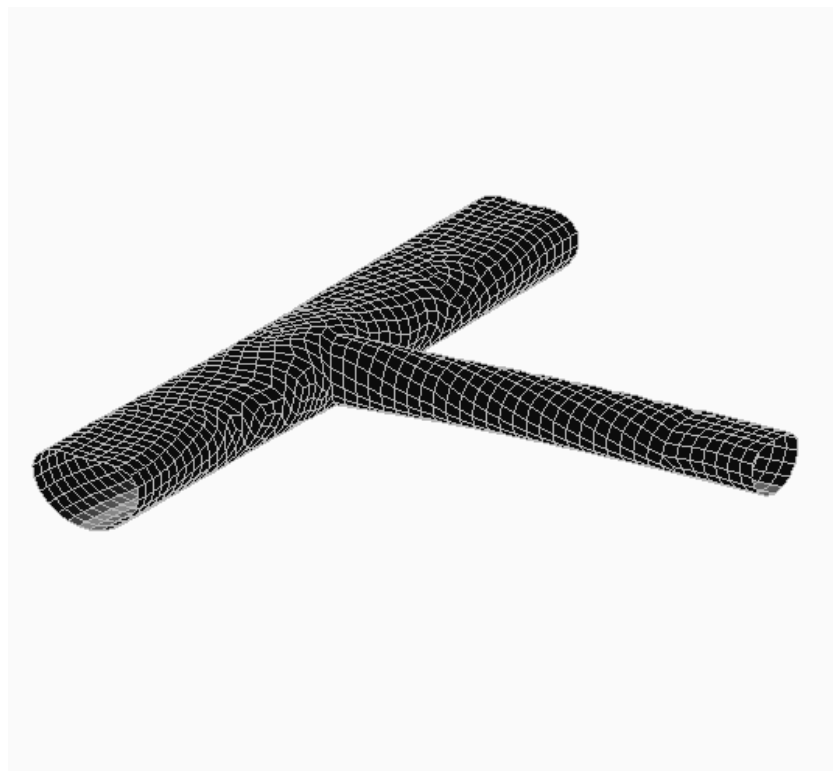
Рис. 5. Деформированный вид тройникового соединения при учете возможного одностороннего взаимодействия и трения.
