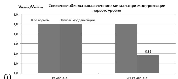
Рис. 21. Уровни абсолютных (а) и относительных (б) снижений объема наплавленного металла при модернизации первого уровня образца (M1_K2).
