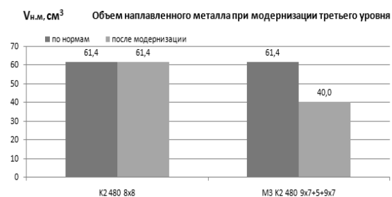
Рис. 22. Уровень абсолютных (а) и относительных (б) снижений объема наплавленного металла при модернизации третьего уровня образца (М3_К1).
