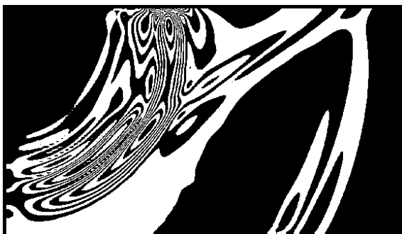
Рис.2. Зеркально отражённая относительно оси x картина полос \tau_{\max} показывает расположение фронтов продольной, конической волны и волны Релея.
