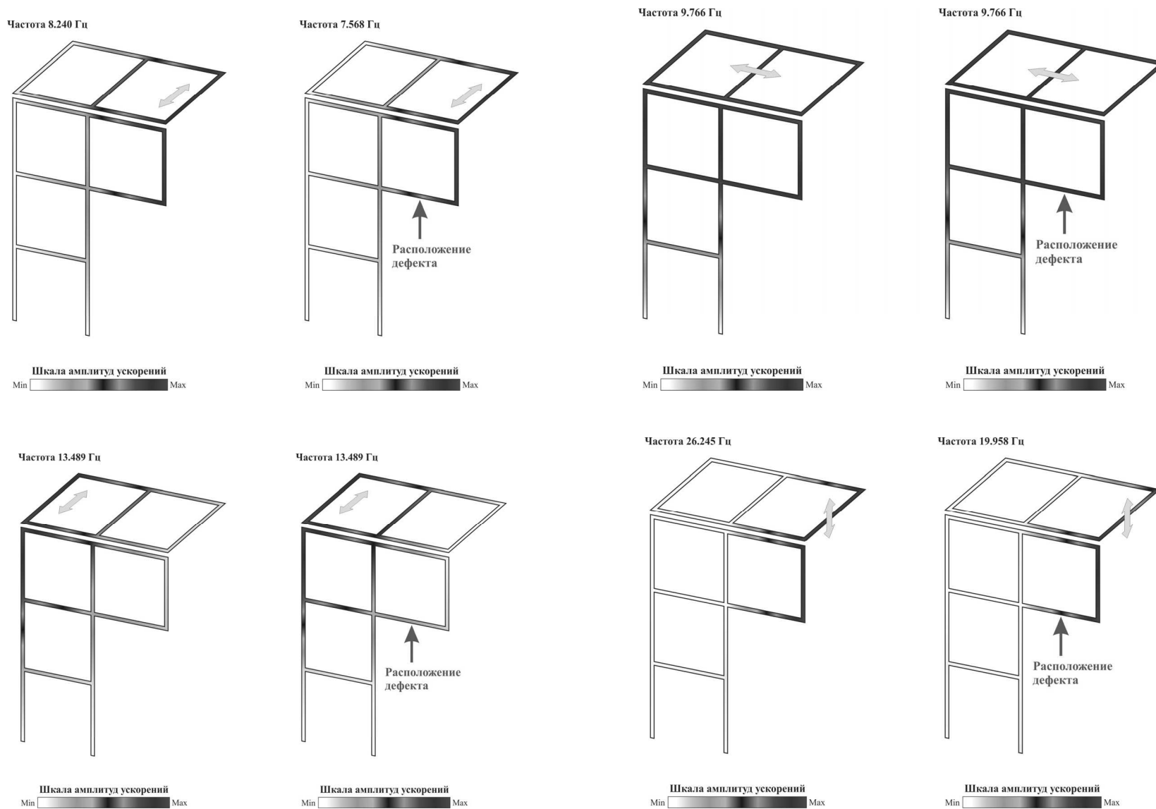
Стенд «Конструктор». Метод «стоячих волн». Измеренные собственные частоты и формы колебаний.
