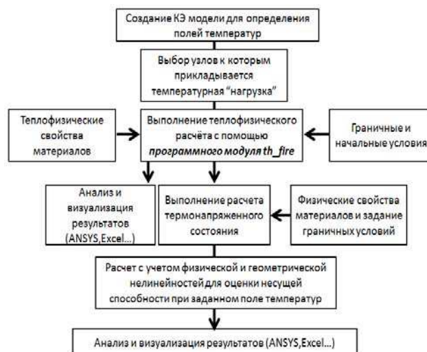
Рис. 1. Блок-схема разработанной методики расчета полей температур и огнестойкости на базе ПК ANSYS Mechanical.
