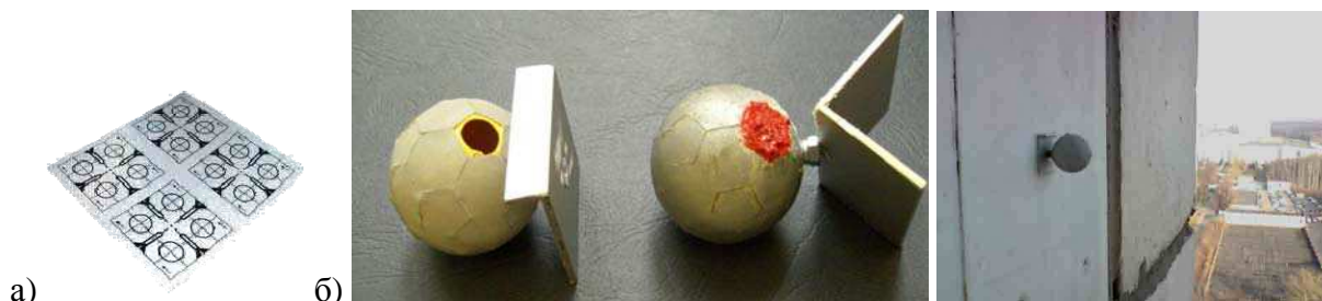
Рис. 2.3. а) Плоские самоклеящиеся световозвращающие марки; б) Сферические световозвращающие марки.
