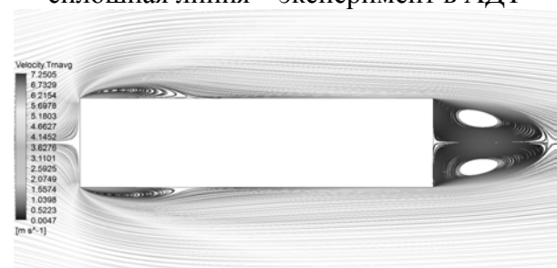
Рис. 6. Линии тока средних скоростей потока. Нестационарный расчет. Модель турбулентности URANS k-\varepsilon
