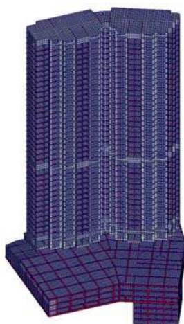
Рис. 2. Общий вид расчетной модели 40-этажного жилого дома.
