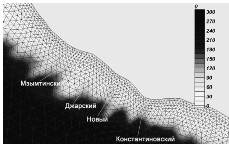
Рис. 4. Неструктурированная расчетная сетка Черного моря в окрестности побережья Сочи. Приведены основные каньоны в районе Имеретинского побережья
