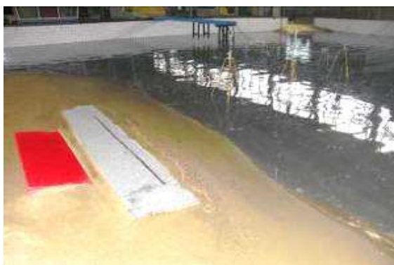
Рис. 2. Модель участка берегозащиты в заполненном водой бассейне
