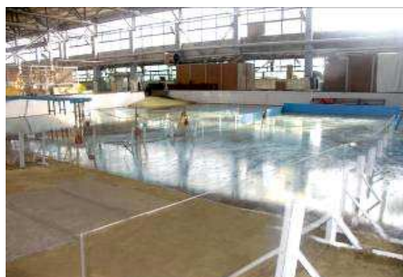
Рис. 4. Подготовленный для экспериментов волновой канал
